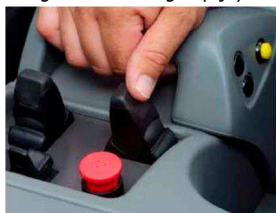
Precisionsreglering av lyft och sänkhastigheten med fingertip-joystick
